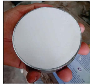
Figura 7. Imperfeições removidas com lixas d'água grão 2000 e 3000. Fonte: Autoria própria (2025).
