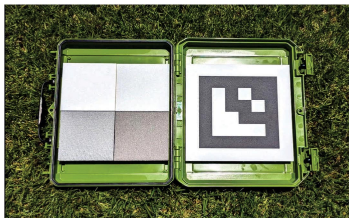
Figura 3: Alvo de solo para a calibração de câmeras multiespectrais. Fonte: Word Wide Brazil (2025)
