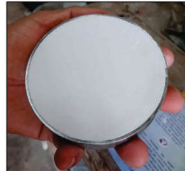
Figura 7. Imperfeições removidas com lixas d'água grão 2000 e 3000. Fonte: Autoria própria (2025).
